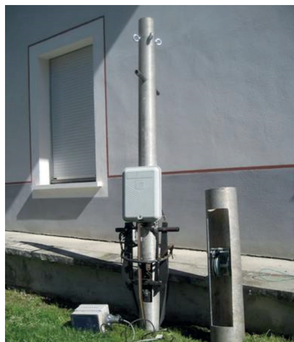
LE MÂT EST CONSTITUÉ DE PLUSIEURS PARTIES, COMME LE DISPOSITIF DE DÉCLENCHEMENT (À GAUCHE) ET LE TREUIL (À DROITE).
