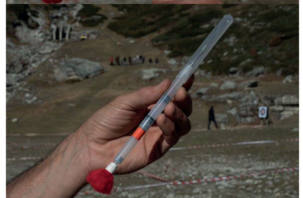
PROTÉGER L'AIGUILLE DE LA FLÉCHETTE POUR LE STOCKAGE ET LE TRANSPORT JUSQU'AU TIR.
