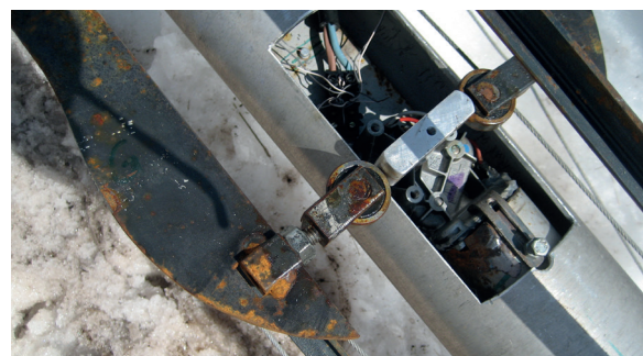
LES BRAS MOBILES ET L'ENTRETOISE PERMETTENT LA CHUTE DU CADRE AVEC FILET QUAND LE PIÈGE EST DÉCLENCHÉ.
