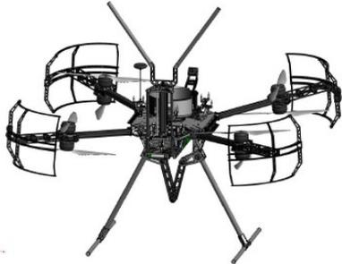
Le drone est guidé par un GPS et une caméra. Le pilote est assisté d'un copilote posté avec un autre angle de vision. Le drone embarque un stock de balises Firefly à son bord. Plusieurs réapprovisionnements seront nécessaires. Le drone chargé pèse environ 13 kg.
